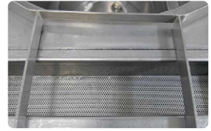
器具の腐食はありません SUS304 - 5年間継続使用例
